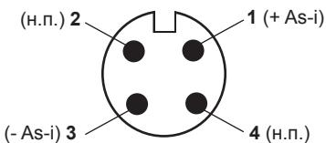
Дополнительный соединитель для четвертого внешнего датчика (S4), гнездовой соединитель M12 x 5 полюсов
